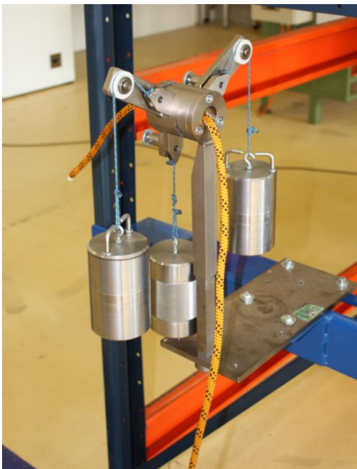
Abb. 18 Vorrichtung zur Aufrauung des Seils
