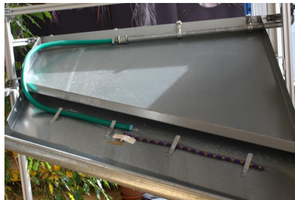
Abb. 19 Bewässerungsanlage für die Testmethode der UIAA
