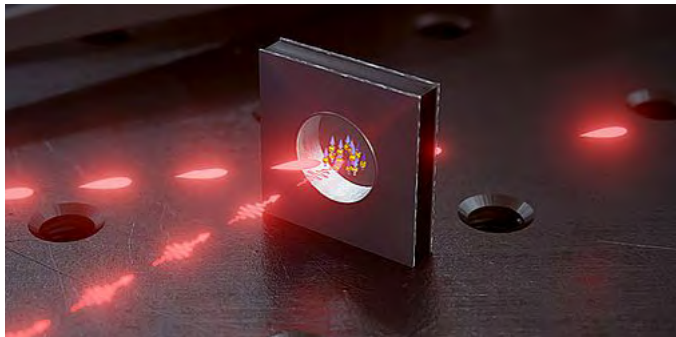
In der nur wenige Millimeter grossen, mit Rubidiumatomen gefüllten Glaszelle können Lichtpulse gespeichert und wieder ausgelesen werden. (Bild: Universität Basel, Departement für Physik/Scixel)
