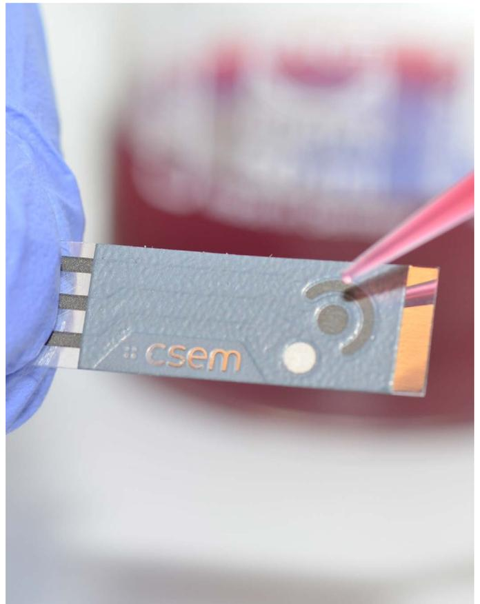
Eine neue Beschichtung von miniaturisierten Elektroden für die patientennahe Labordiagnostik verhindert Verunreinigungen – ein Problem bei komplexen Proben wie Blutserum. (Bild: CSEM Allschwil)
