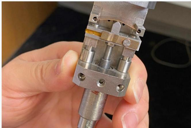
Abb.: Durch Druck von unten verbiegt sich das Bauelement. Dadurch verlängert sich die eingebettete Graphenschicht, und ihre elektrischen Eigenschaften ändern sich. (Bild: SNI, U. Basel)
