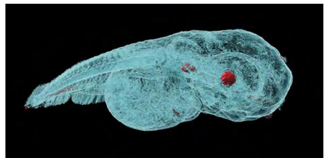
Mittels Mikrotomografie im Phasenkontrastmodus gelangen hoch aufgelöste, dreidimensionale Aufnahmen von Zebrafisch-Embryos, in denen die Verteilung von Nanopartikeln (rot) sichtbar wird. Ebenfalls rot und gut zu erkennen aufgrund der hohen Dichte sind die Auglinse und die Otolithen im Innenohr, also Kalksteinchen des Gleichgewichtsorgans (Bild: Universität Basel, Jan Bolten)
