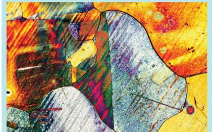
**Gulibusitan Abulizi, Universität Basel:** Oxidierte polykristalline Kupferfolie mit einer Monoschicht von hexagonalem Boronitrid auf der Oberfläche
