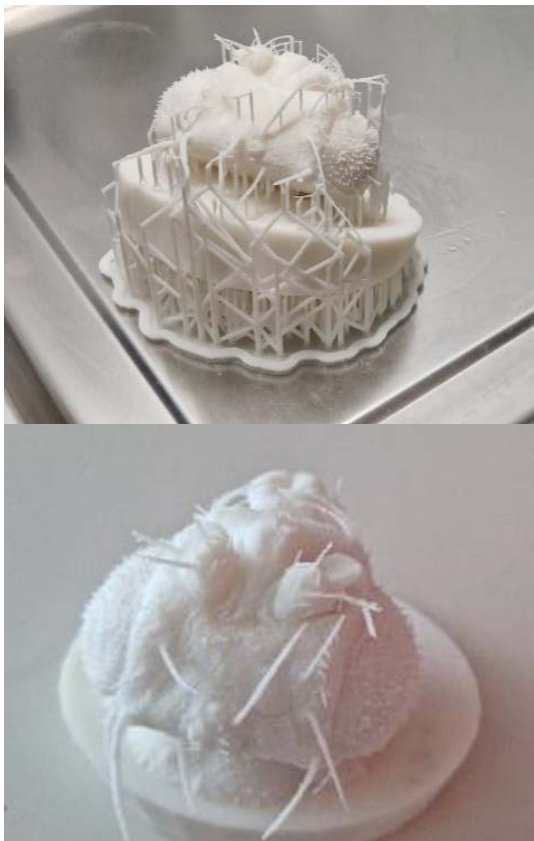
Modell eines Fruchtfliegenkopfes mit und ohne Stützstrukturen basierend auf rasterelektronenmikroskopischen Aufnahmen. (Bild: Y. S. Bader)
