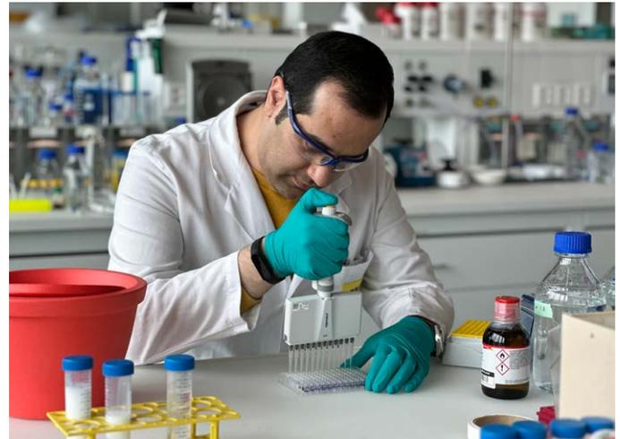
Amir Nazemi bereitet einen Test zur Quantifizierung von Proteinen vor, um die Effizienz der Immobilisierung zu untersuchen und die Menge des auf den Silika-Nanopartikeln immobilisierten Enzyms zu messen. (Bild: FHNW)
