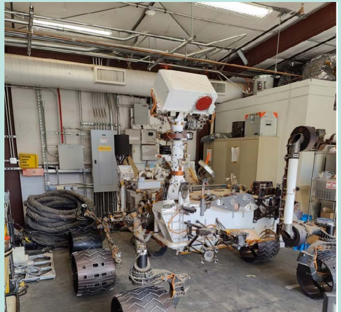
MAGGIE (Mars Automated Giant Gizmo for Integrated Engineering): Ein perfektes Double des Curiosity Rovers (ohne den Radioisotop-Thermoelektrischen Generator, aus offensichtlichen Gründen). Dieses Gerät wird genutzt, um den richtigen Rover aus kritischen Situationen herauszubekommen. Dazu werden eben jene Situationen im «Mars-yard» nebenan nachgestellt, und, mit Trial-and-Error, Kommandosequenzen erarbeitet, welche den echten Rover wieder in den Normalzustand bewegen können.
